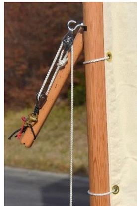
Das Sprietfall ist übersetzt und wird auf einer Klampe am Schwertkasten belegt, die Spriet kann leicht ausgehängt werden (Sicherheit)
