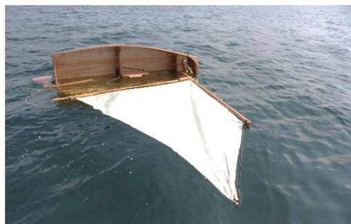
Der Holzmast lässt das Boot kaum durchkernern und das Boot ist auch ohne Auftriebskörper ausreichend schwimmfähig.
