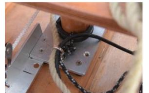
Der einteilige und nicht einstellbare Mastfuß mit einer Gummimuffe zur Aufnahme des Mastes (Grundeinstellung Mastfuß 2,84m, nicht veränderbar, Verschraubung hier noch provisorisch)
