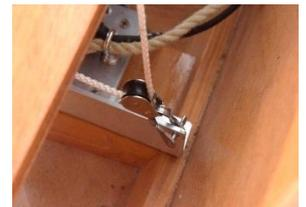
Die Umlenkung des Sprietfalls am Mastfuß
